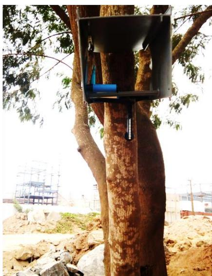
Figure 3-13 : Mise en place des tubes Radiello et Dräger sur le domaine de TIPSP
