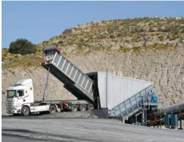
**Figure 2-34 : Exemple d'une fosse de déchargement avec tuyau d'alimentation**
