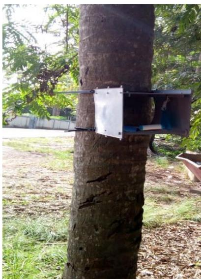
Figure 3-14 : Installation du dispositif de RADIELLO au quartier Rade
