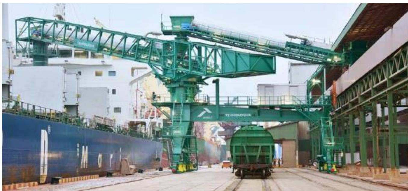
**Figure 2-33 : chargeur de navire**
