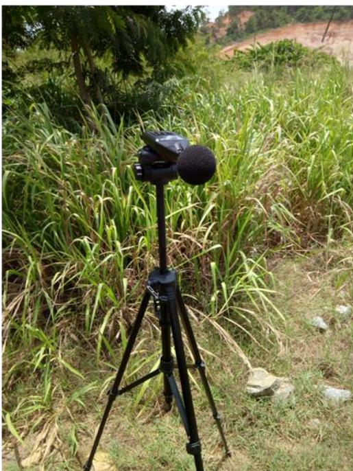
**Figure 3-18 : Disposition du sonomètre pour les mesures de bruit (Jour)**
