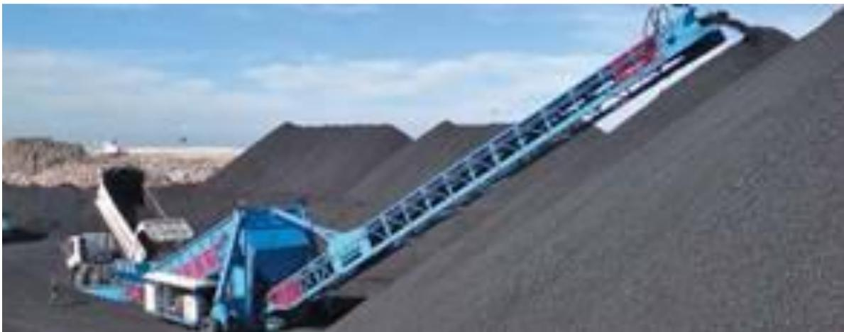
**Figure 2-35 : Exemple d'empileur mobile avec margeur**
