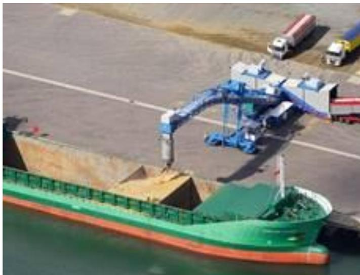
**Figure 2-36 : Exemple d'un chargeur mobile de navires alimenté par un camion**
